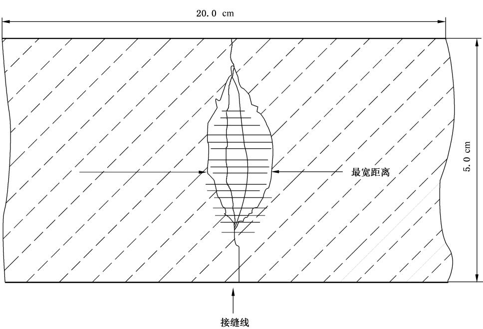
图 C.1 接缝脱开距离
